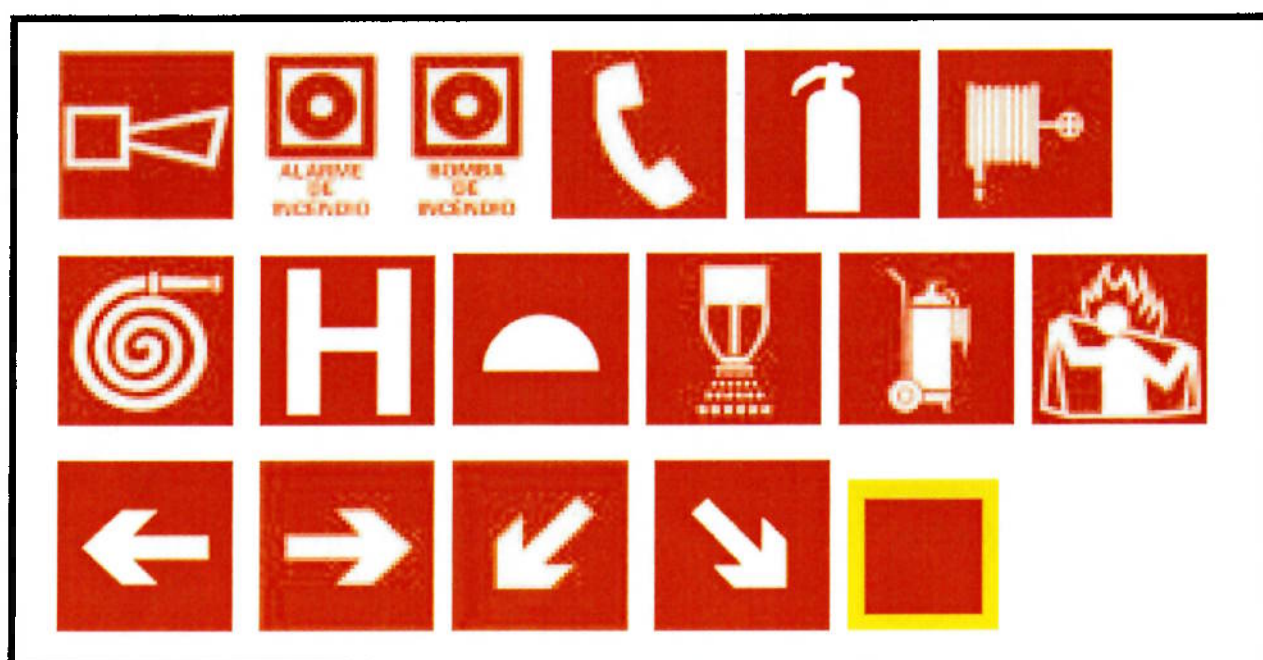
Figura 6.23 – Sinalização de equipamento
